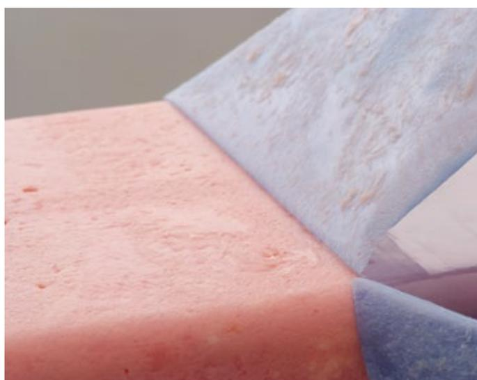
*Excesiva adherencia de la carne en la superficie interna de la tripa durante el proceso de pelado*
